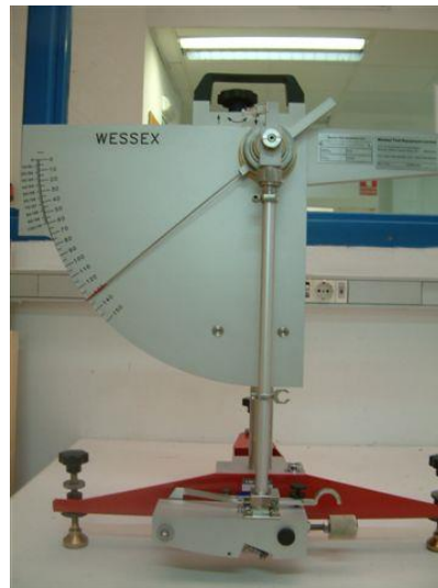
Detalle del equipo de “Resistencia al deslizamiento”
